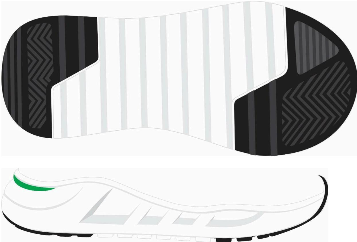
**Entressola** peça macia com amortecimento de impactos com cortes aerodinâmicos na parte externa, constituída policloreto de vinila expandido monodensidade, na cor branca. Unida a soleta pelo processo denominado colado com aplicação de adesivos à base de água. Conforto, amortecimento de impactos, auxílio na escoação de líquidos externos, auxílio na formação visual.
