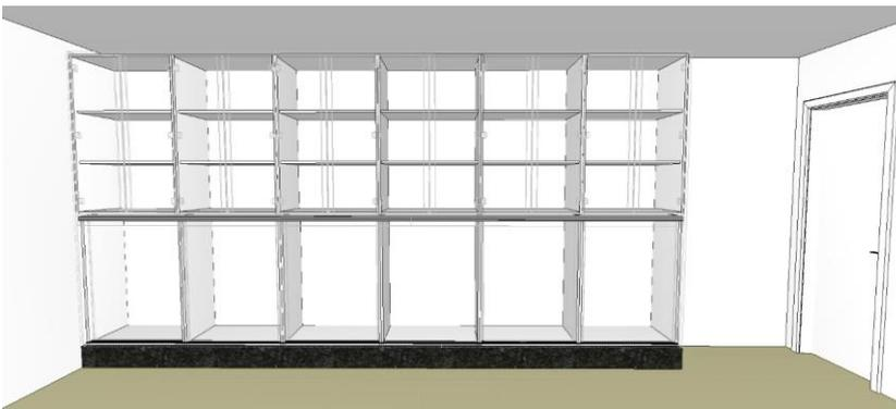
A parte inferior do armário livre (sem divisórias) medindo 1.10m de altura e com portas de correr. E a parte superior com portas de abrir, e prateleiras com aproximadamente 0.40m de altura entre cada uma. Puxador gola de alumínio.
