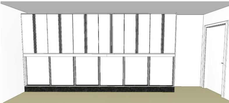
Item 1: 01 armário suspenso com 06 módulos medindo no total 5.25m de comprimento, 0.60m de profundidade e 2.50m de altura, suspenso do chão com pés e fechamento em granito cinza ocre.
