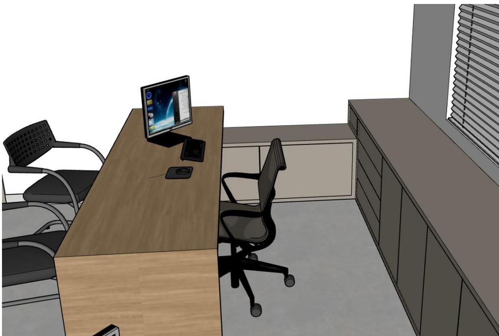
Item 4: 01 nicho medindo 2,20m de comprimento, 0,40 de altura e 0,25m de profundidade
