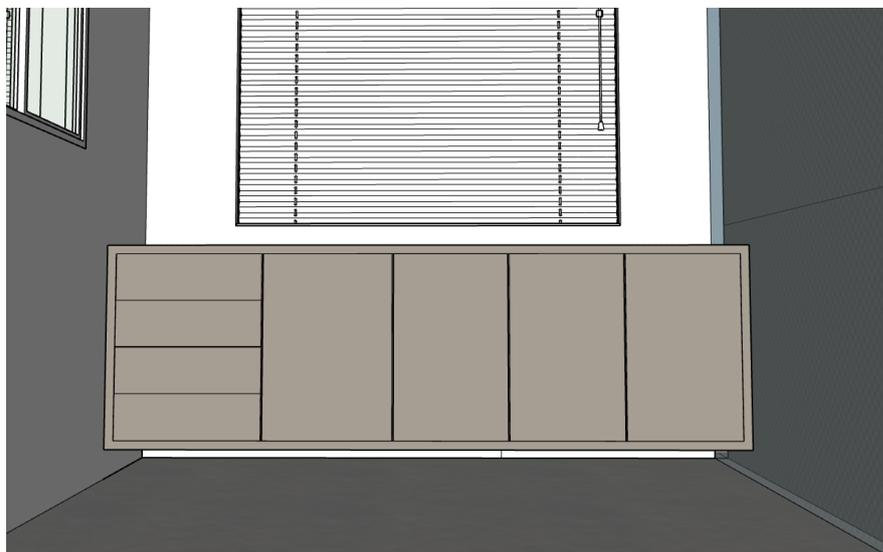
Item 2: 03 unidades de balcão, suspenso 10cm do piso, medindo comprimento de 2,20m, profundidade de 0,50m e altura de 0,75m. Contendo 04 gavetas com 0,50m de largura, e 04 portas com prateleira interna. Com tamponamento de espessura de 30mm. Puxadores e cores a serem escolhidos pela fiscalização.
