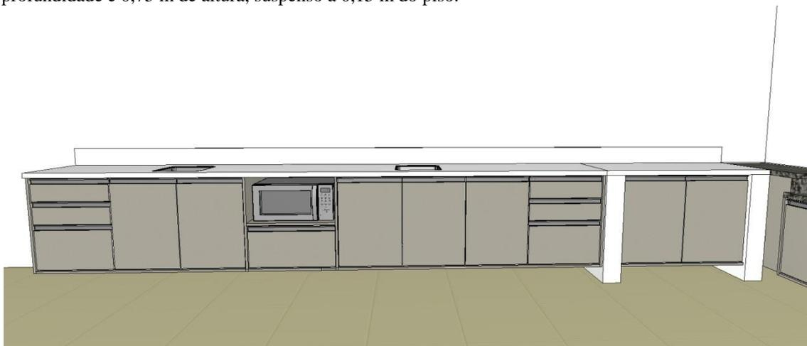
Item 02: 01 balcão para cozinha com 04 portas com prateleiras internas, puxador gola, medindo 2,00 m de comprimento, 0,50 m de profundidade e 0,60 m de altura, suspenso a 0,15 m do piso.
