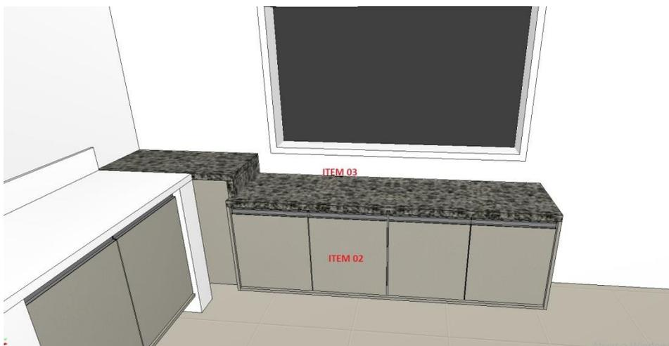
Item 03: tampo de granito na cor cinza ocre, medindo 2,90 m de comprimento, 0,50 m de profundidade e 0,40 mm de espessura, conforme projeto.
