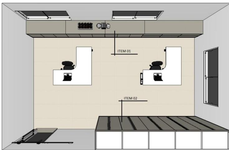
Item 1: 01 balcão com 09 portas com prateleira interna e 06 gavetas com puxador gola, tampo de 30 mm de espessura, medindo 6,80 m de comprimento, 0,55 m de profundidade e 0,75 m de altura, suspenso a 0,15 m do piso, conforme projeto:
