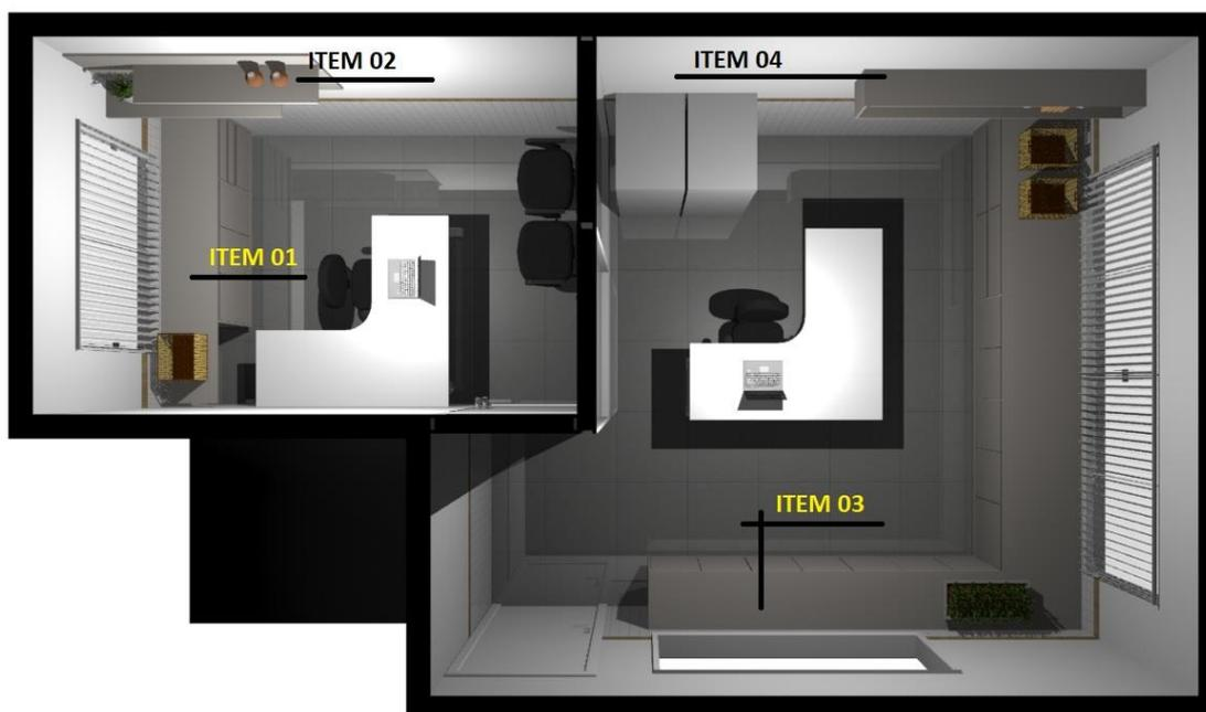
Item 01: 01 armário com 03 portas com prateleiras internas, 03 gavetas, com tampo de 30 mm de espessura, puxador gola, medindo 2,25 m de comprimento total, 0,40 m de profundidade e 0,75 m de altura, suspenso a 0,15 m do piso, conforme projeto.
