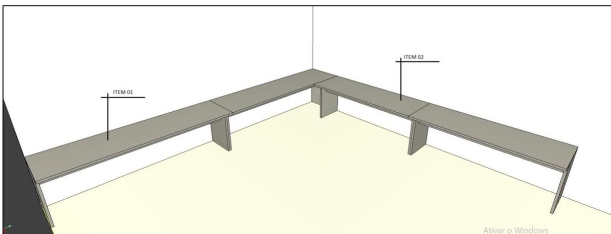
Item 01: 02 unidades de bancada de 30 mm de espessura, medindo 2,50 m de comprimento, 0,70 m de profundidade e 0,74 m de altura com pés recuados 0,20 me com saia para sustentação de 0,25 m, conforme projeto.
