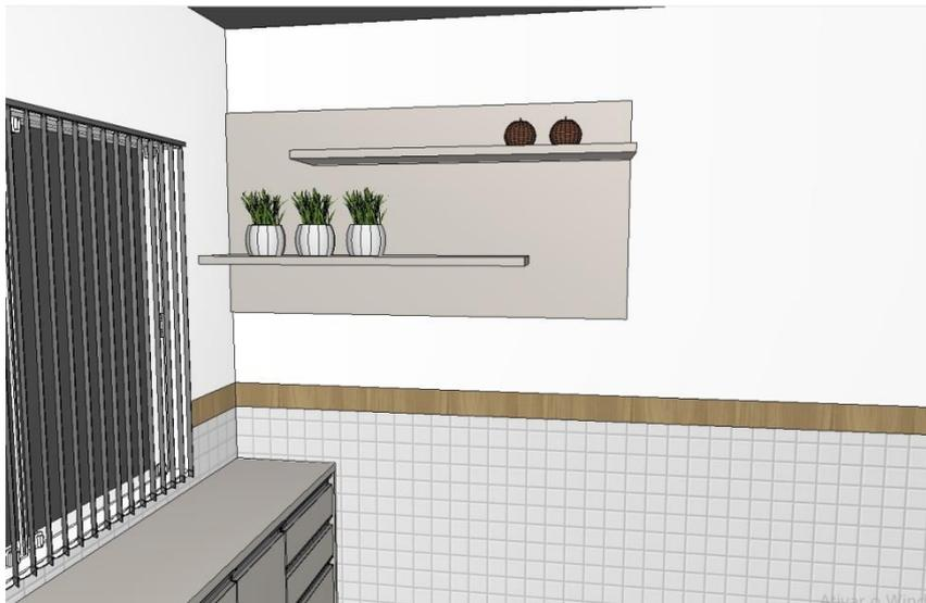
Item 03: 01 balcão em L com 12 portas com prateleiras internas e 04 gavetas, com puxador gola, medindo: LADO A: 2,70 m de comprimento, 0,45 de profundidade e 0,75 m de altura, suspenso a 0,15 m do piso. LADO B: medindo 4,0 m de comprimento, 0,60 m de profundidade e 0,75 m de altura, suspenso a 0,15 m do piso.
