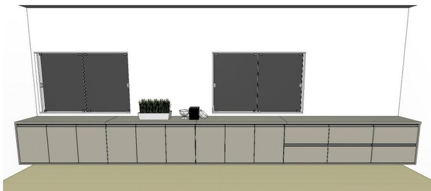
Item 2: 01 armário com 10 portas, com prateleiras internas a cada 0,40 m, com puxador gola, medindo 4,40 m de comprimento, 0,45 m de profundidade e 2,65 m de altura, suspenso a 0,15 m do piso, conforme projeto:
