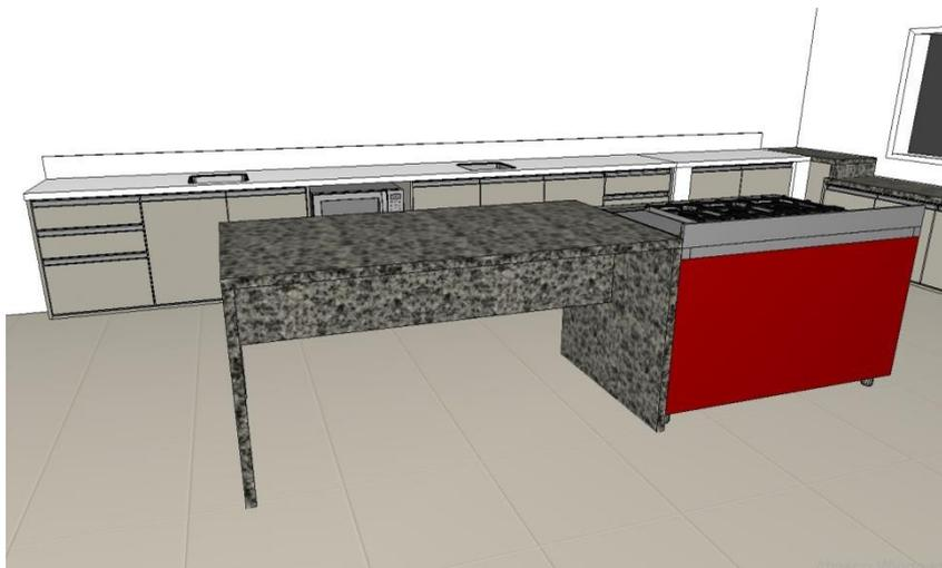
Item 05: 01 bancada em granito na cor cinza ocre, para suporte de bebedouro medindo 0,80 m de comprimento, 0,50 m de profundidade, suspenso do piso, fixado com duas mãos francesas.
