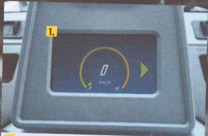
1. Display LCD com velocímetro e indicadores do acionamento das luzes dianteiras e de direção.
