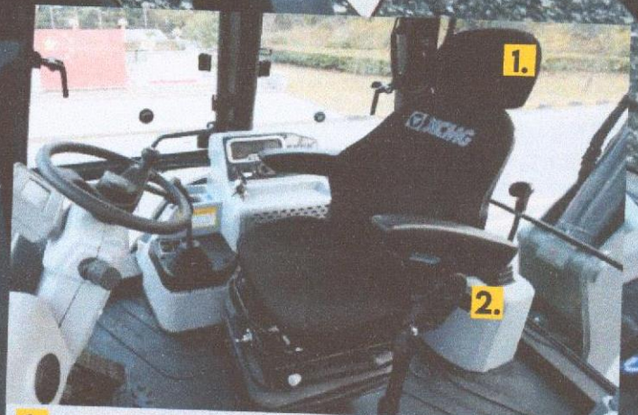
1. Banco do operador ergonômico com apoio de braço, suspensão mecânica regulável, com giro de 180°. 2. Cinto de segurança retrátil.
