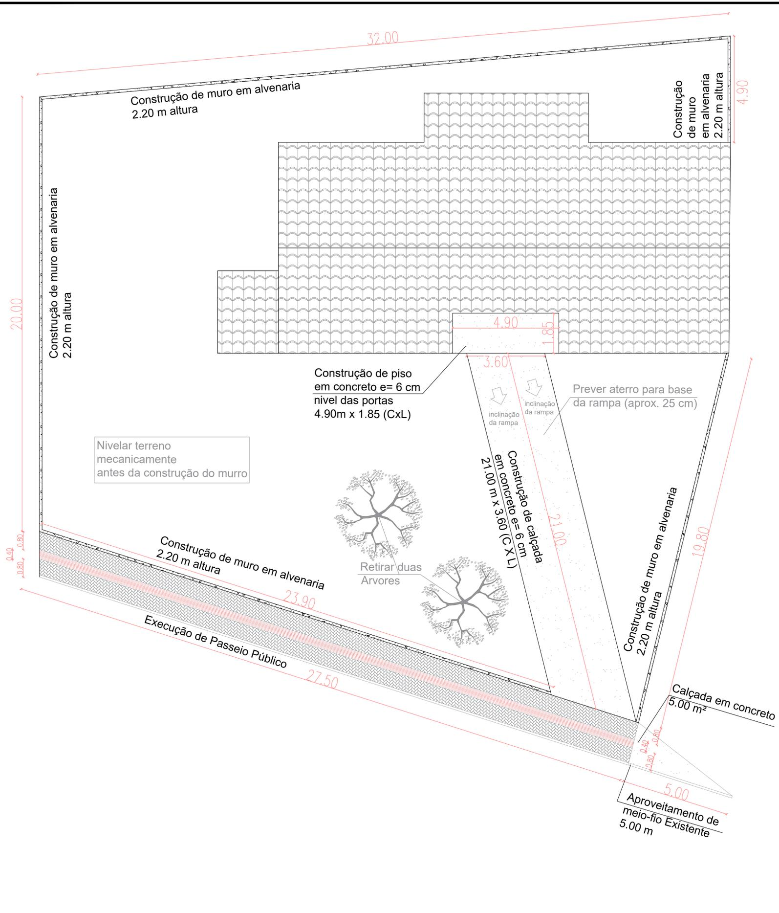
DETALHAMENTO MURO A CONSTRUIR
