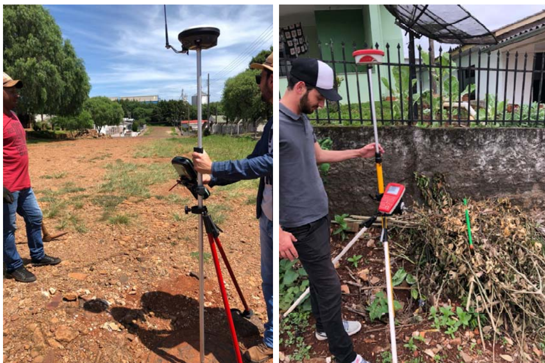
Fotos 01 e 02: Equipe de topografia realizando o cadastro dos PVs.
